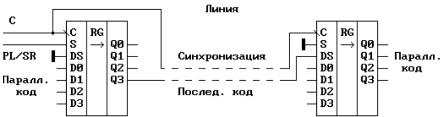
Рис. 4.4. Пример организации связи между регистрами с преобразованием параллельного кода в последовательный
