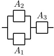
**Решение.** Пусть  $A_k$  означает событие, состоящее в том, что  $k$ -й элемент неисправен.  $A = \{\text{проходит ток}\}$ ,  $A = \bar{A}_3(\bar{A}_1 + \bar{A}_2)$ .  $P(A) = P(\bar{A}_3)P(\bar{A}_1 + \bar{A}_2) = (1 - p_3)(1 - p_1 + 1 - p_2 - (1 - p_1)(1 - p_2)) = (1 - p_3)(1 - p_1p_2)$ .
