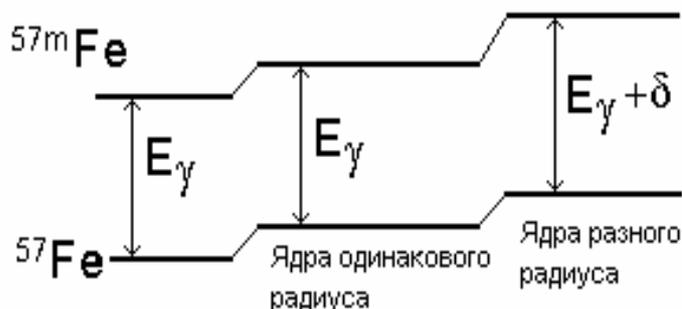
Рис. 3. Влияние конечного размера ядра и различия радиусов в основном и возбужденном состоянии на схему энергетических уровней ядра.
